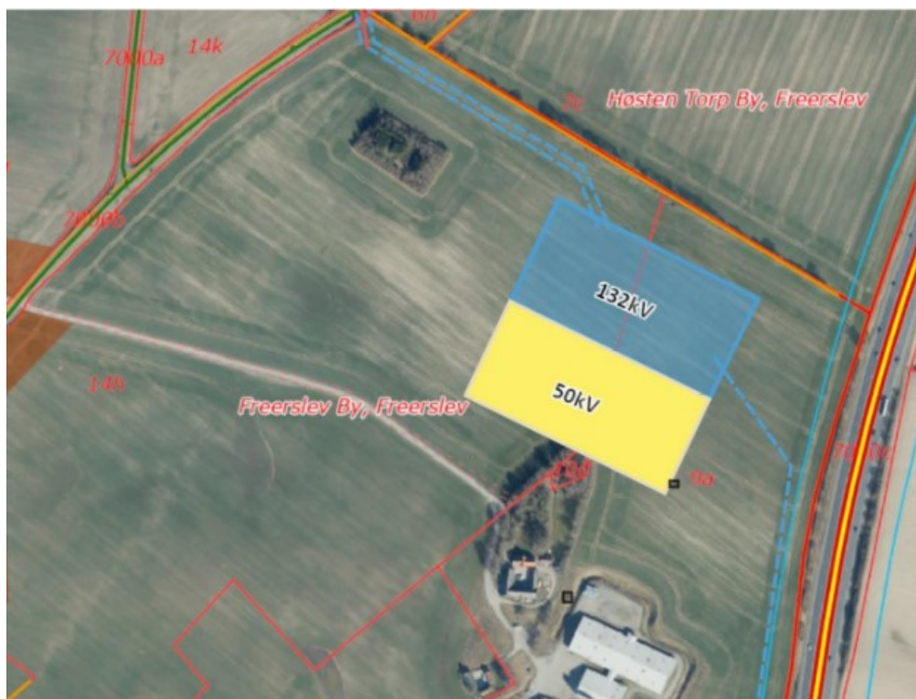
Figur 1-2. Areal til ny station Haslev Øst. Den blå flade viser Energinets nye stationsareal. Den gule flade er areal til station for det lokale netselskab Andel Holding.
