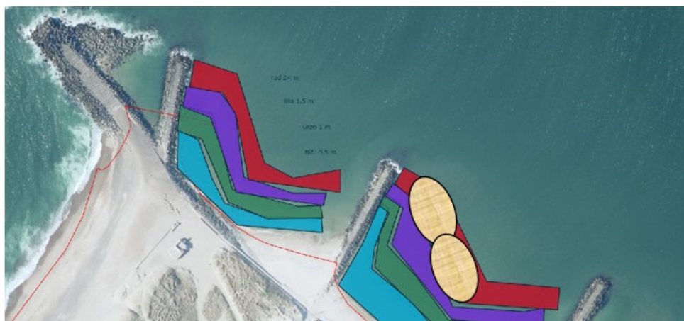
Figur 1. Resultat af forenklede dybdemålinger med målestav. Dybderne 2 m, 1,5 m, 1 m og 0,5 m er vist med hhv. rød, lilla, grøn og blå. Den teoretiske placering af geotekstil sække med sand er vist som sandfarvede ovale polygoner.
