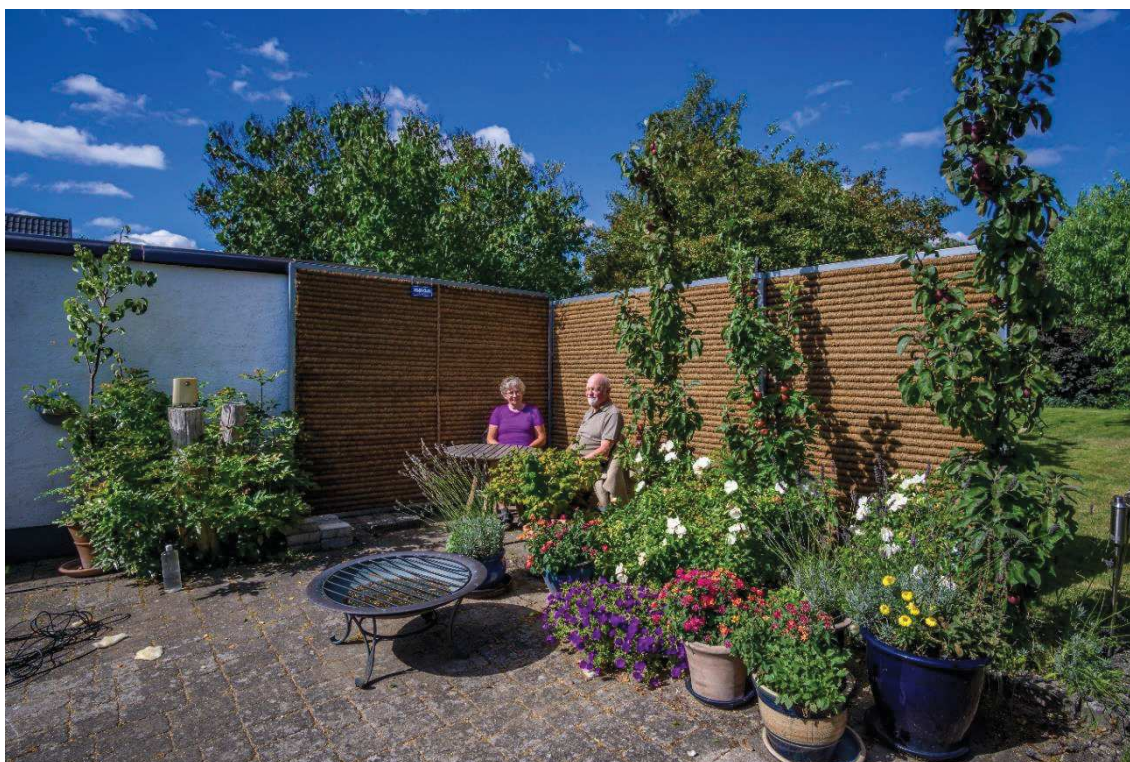
Figur 24. Et støjhegn kan skabe en støjfaskærmet krog eller terrasse. Den støjdæpende virkning kan opleves i et mindre område lige op af hegnet (fra en forsøgsopstilling i en have i Glostrup).
