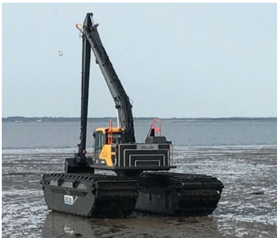
Figur 8-2 Eksempel på amfibiegravemaskine, der både kan køre og sejle.
