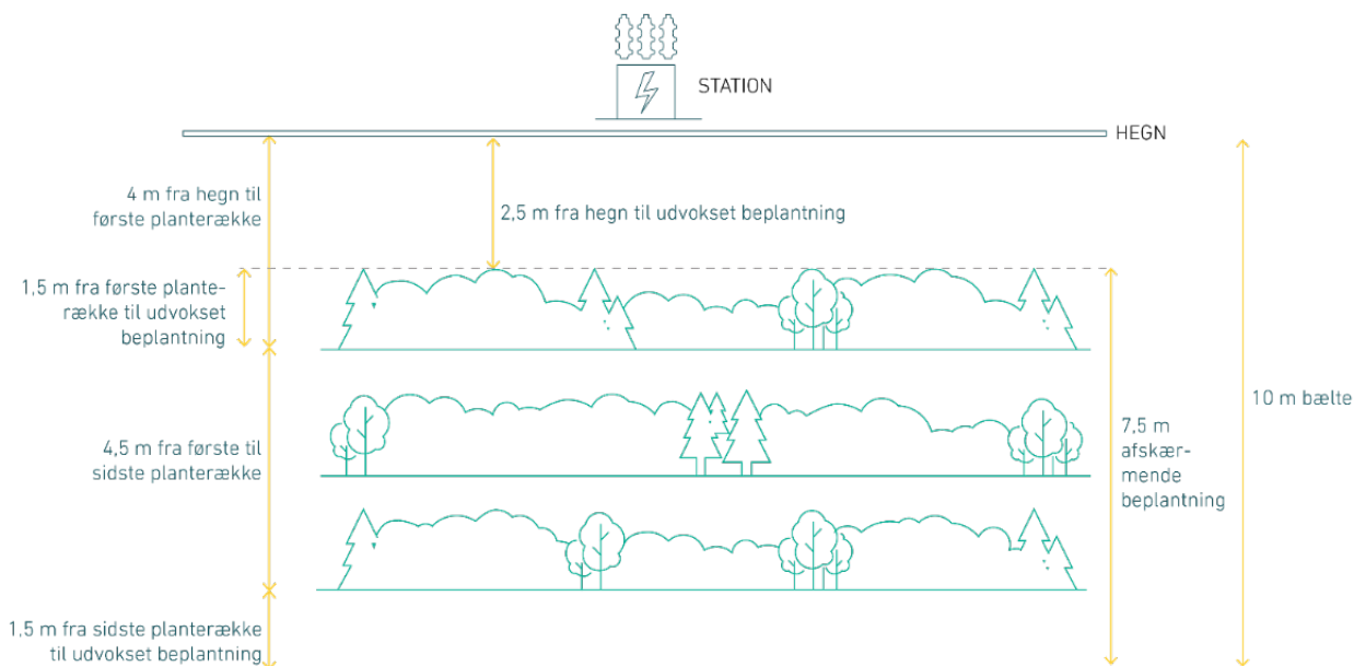
Figur 6-7. Principtegning over Energinets standard beplantningsbælte. Der plantes som udgangspunkt hjemmehørende gerne egnstypiske arter i varierende højde.
