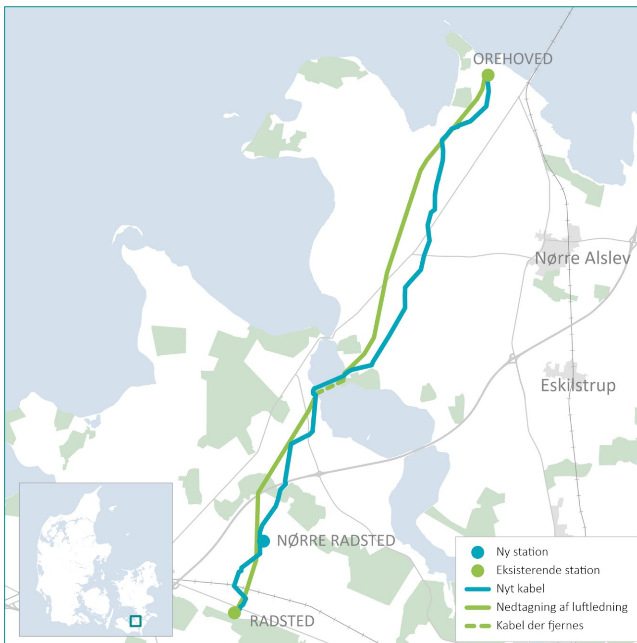
Figur 1-1. Oversigtskort over projektet. Eksisterende luftledningssystem (gul streg), nyt kabelanlæg (blå stiplede), eksisterende højspændingsstationer (blå prik). Projektet har en udstrækning på ca. 25 km.
