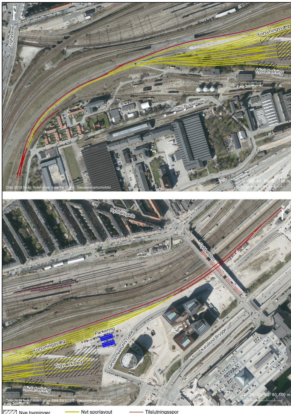
Figur 2 Skitse over tilslutningsspor, sporlayout og placering af togværksted, hjulafretning, forsyningsvæg og p-pladser.
