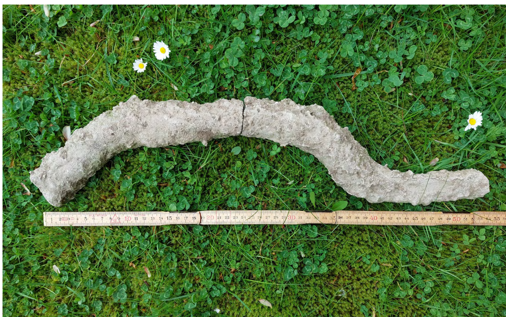
Fig. 2.7 Afstøbning af muldvarpegang i et dige. Gangen er 54 cm lang.
