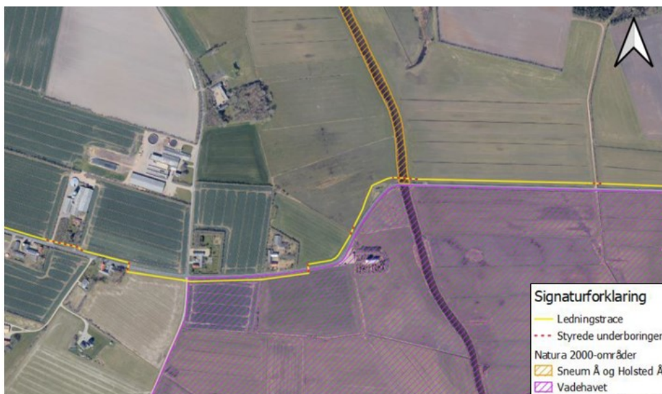
Figur 9 – oversigt over ledningstracéet (gul) med angivelse af placeringen af Natura-2000 områderne N90 (Sneum Å og Holsted Å, orange) og N89 (Vadehavet, lilla). Krydsning af Sneum Å sker med styret underboring i N90, ca. 10 meter opstrøms N89.
