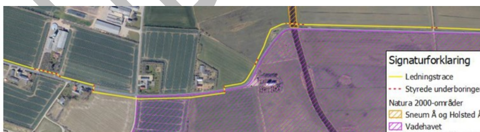
Figur 10 – oversigt over ledningstracéet (gul) med angivelse af placeringen af Natura-2000 områderne N90 (Sneum Å og Holsted Å, orange) og N89 (Vadehavet, lilla). Krydsning af N89 sker perifert med åben grav på en delstrækning på ca. 300 meter.
