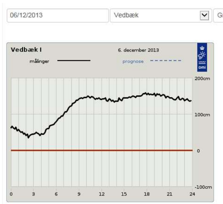
Figur 2 Vandstand i Vedbæk under Bodil.
