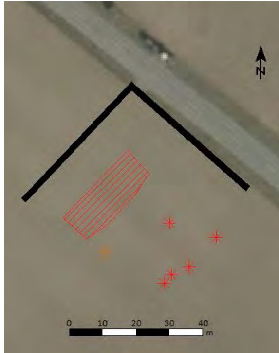
Figur 2: principtegning med placering af støjskærm ved Farø syd. Støjskærm fremgår som sort streg.
