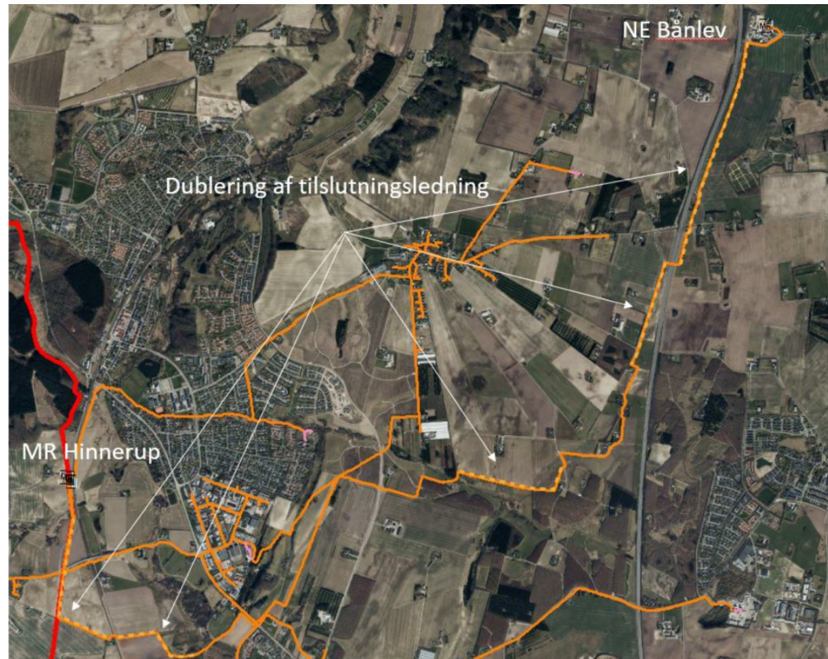
Figur 2: Kort over ændringer i ledningsnettet til naturgas.
