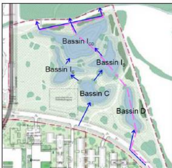
Figur 2. Vandets vej gennem bassinerne. De blå pile indikerer overfladevand, den stiplede lilla linje indikerer rensede hospitalsspildevand
