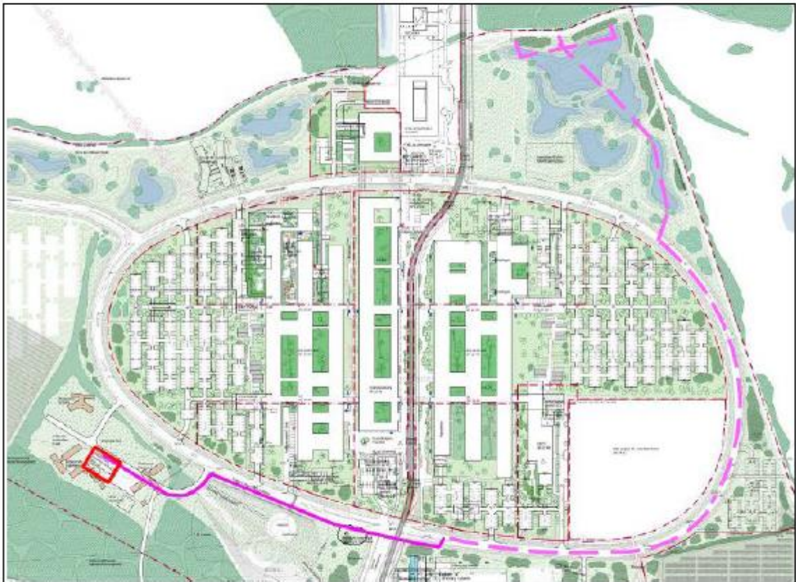
Figur 1. Oversigt over afvanding og rensning på Nyt Odense Universitetshospital (OUH). Den optrukne lilla linje er en trykkledning fra OUR renselanlæg til en afskærende regnvandsledning langs med ringvejen illustreret ved den stiplede lilla linje
