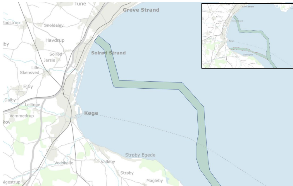
Figur 5 – Udsnit af projektområdet for søkablets placering i Køge Bugt. Den sydlige rute af søkablet ind til Vallø Strand (vist på det lille kortudsnit) bortfalder med den ansøgte projektændring.
