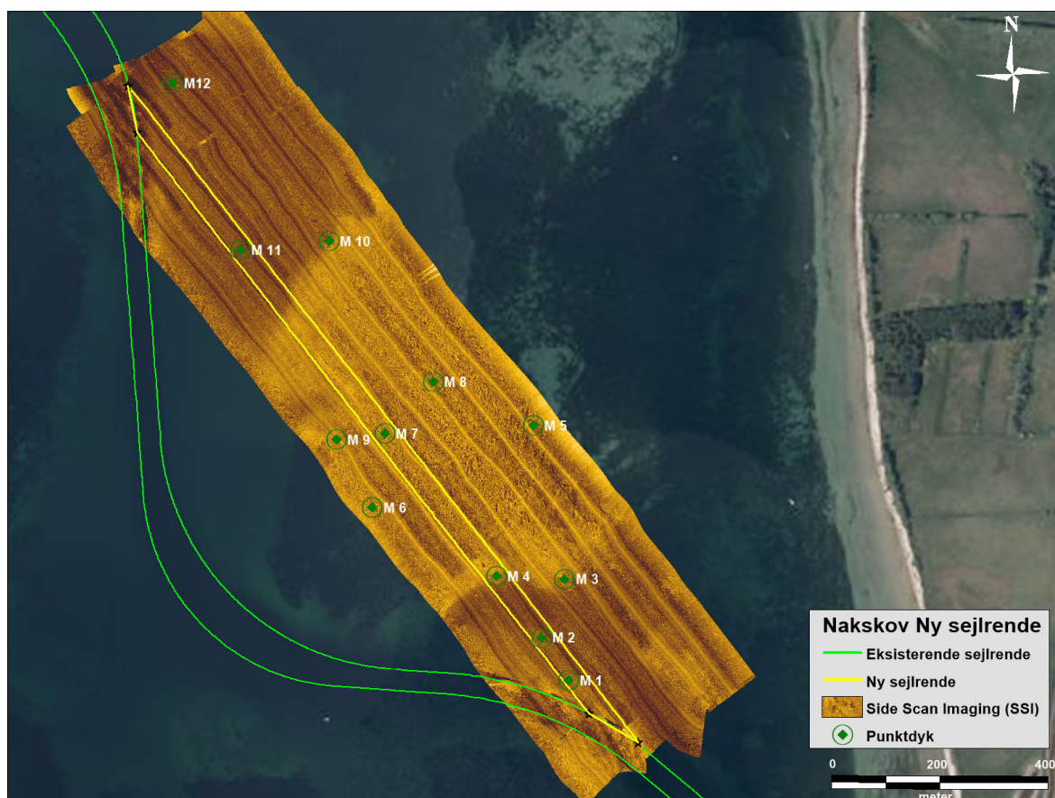
Figur 4: Side scan imaging (SSI) ekkogram med tilhørende punktdykstationer til verifikation af substrattyper samt undersøgelse af marin flora og fauna i undersøgelsesområdet.
