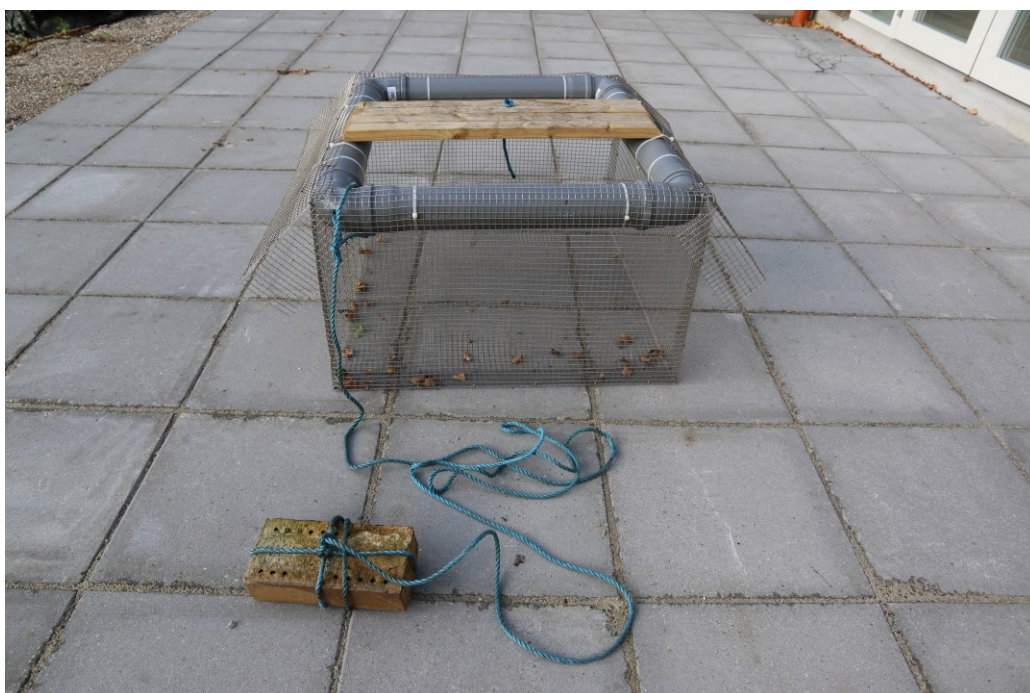
Flydefælde, konstrueret i 75 mm afløbsrør, rustfrit stål gitter og forankret ved brug af mursten og reb.
