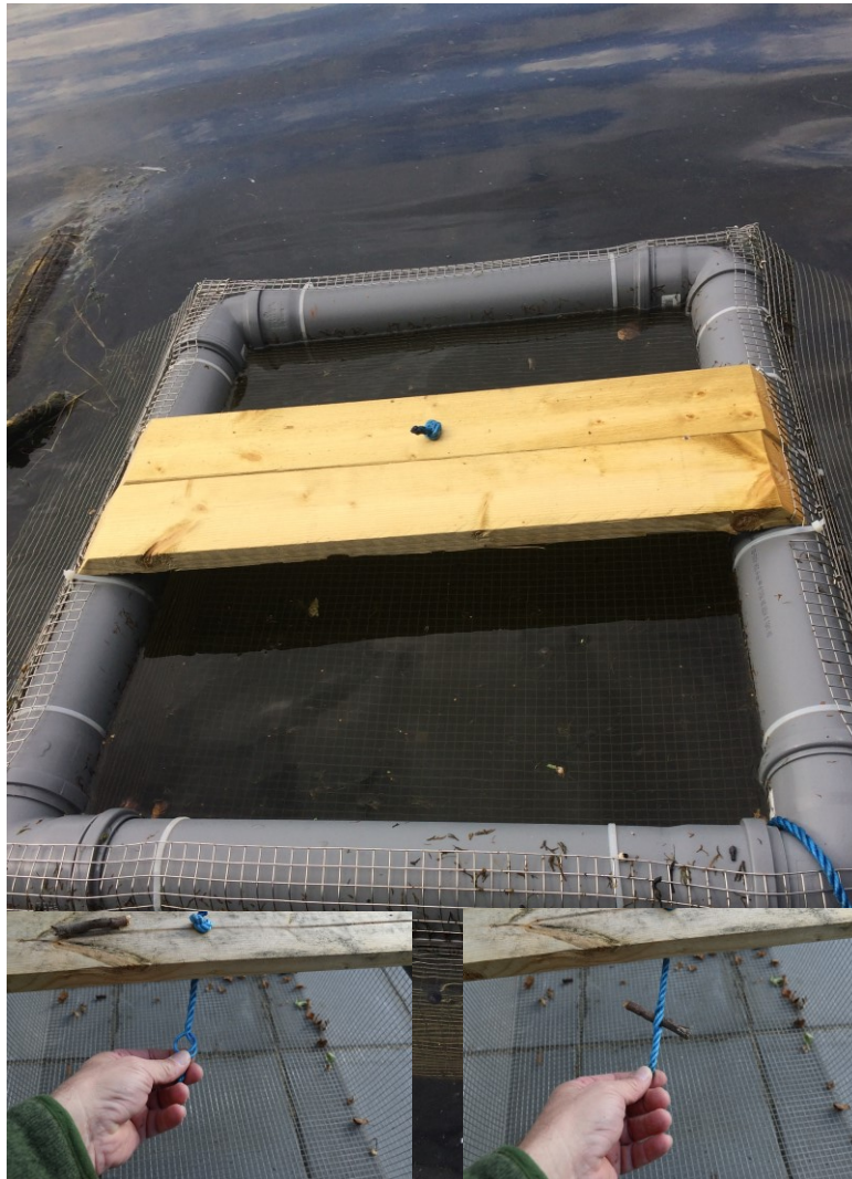
Flydefælde opsat, montering af oksehjerte under brættet. Pinden illustrerer oksehjertet.
