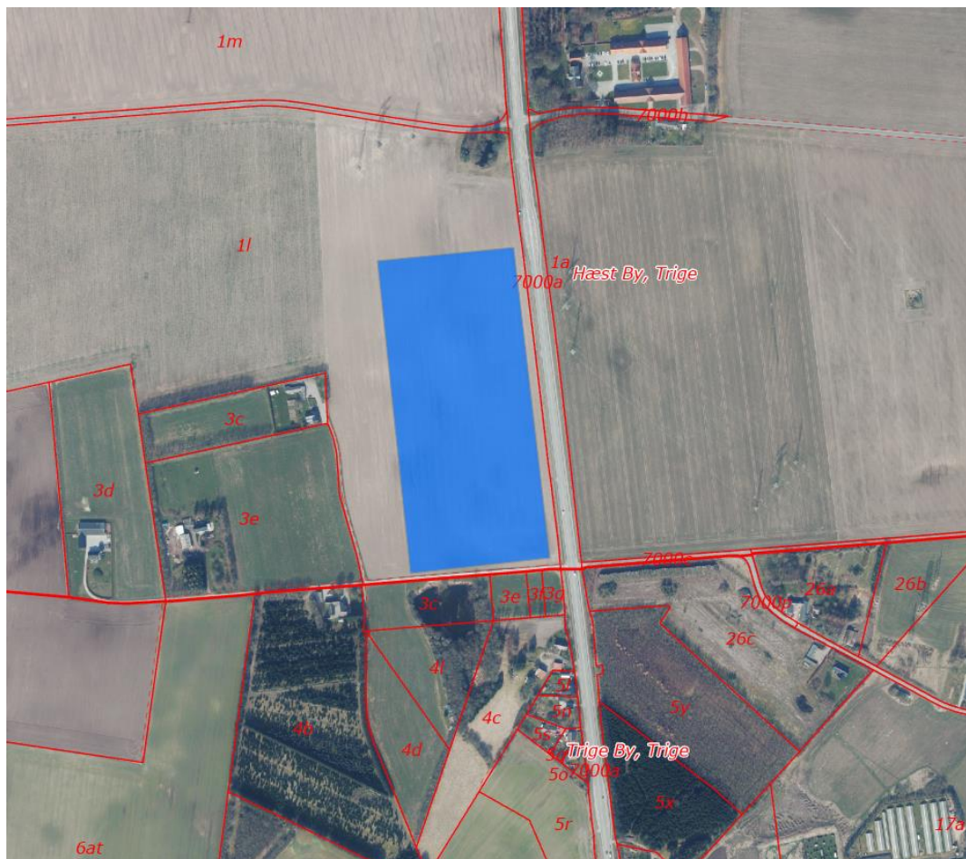
Figur 4-4. Den nye koblingsstation placeres i Aarhus Kommune syd for den eksisterende station Trige og tilkobles denne. Arealet til stationen udgør ca. 7,2 ha (400x180m).
