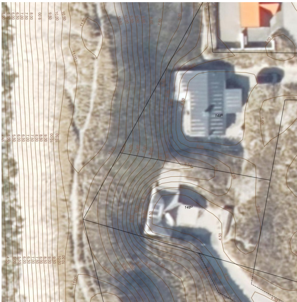
Fig. 2. Ortofoto 2023. På figuren fremgår det, at sommerhusene er opført i kote 4,5, mens toppen af klitten umiddelbart vest for husene ligger i kote 10,5-11.
