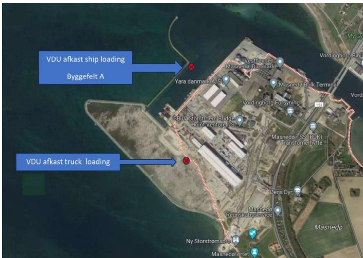
Figur 26: Placering af afkast for dampdestruktionsanlæg (VDU) med termisk oxidation på projektområdet og byggefelt A (multiplier). Arcadia eFuels.
