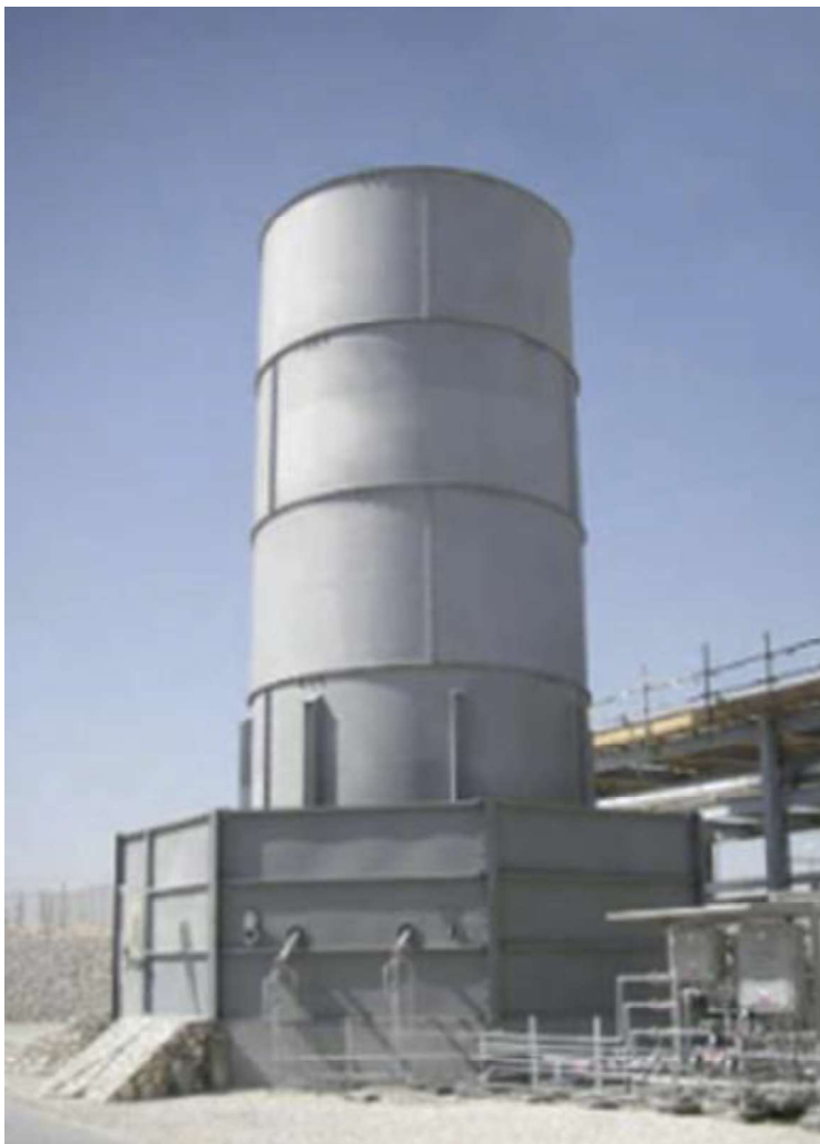
Figur 16: Eksempel på ground flare med "lukket fakkel".
