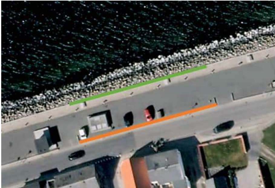
Figur 7: Klimasikring hvor Grøn = Formur (+2,2)/ Orange = Bagmur (+2,0).
