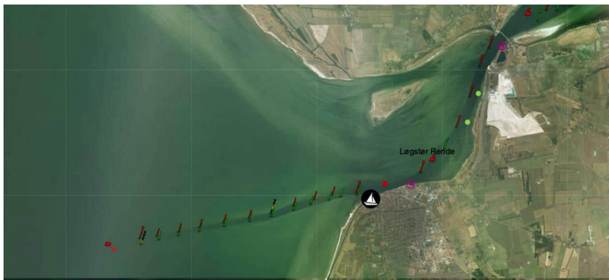
Figur 3-1. Eksisterende sideafmærkning på strækningen mellem Løgstør Grunde og Aggersundbroen i Limfjorden. På kortet er desuden angivet forslag til placering af nye sideafmærkninger, som skal være med til at opretholde sejladsikkerheden i området som følge af udvidelsen af Løgstør Marina.
