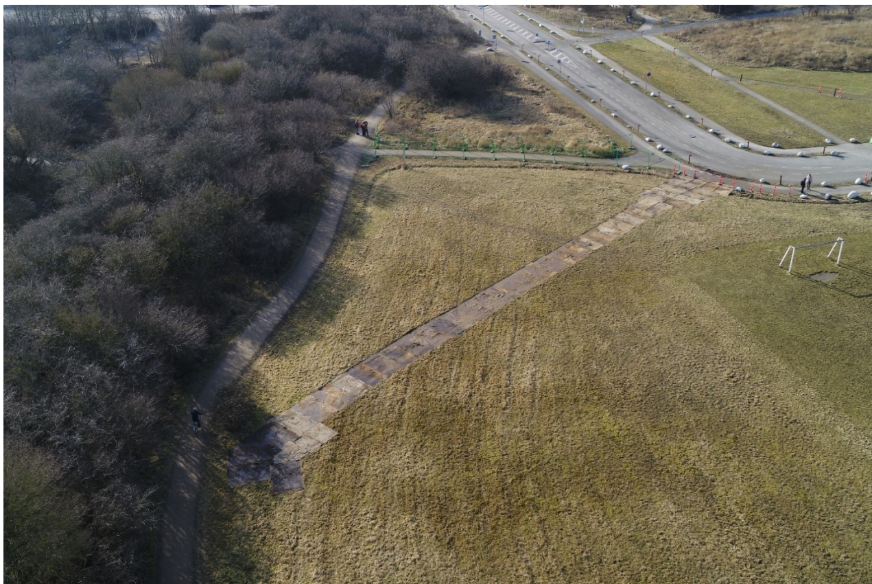
Figur 7. Luftfoto af de udlagte kørepladder
