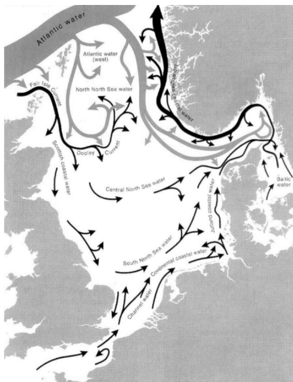
Figur 18-3 Skematisk gengivelse af den generelle cirkulation i Nordsøen, Skagerrak og Kattegat. De mørke pile viser overfladestrømme mens de lyse pile viser strømmingen i dybden. Tykkelsen indikerer styrken af de forskellige transporter. Således ses, at det Norske Kystvand tilføres store mængder vand fra tilstødende floder hvorved den bliver bredere. Sammenholdes figuren med figur 2.1 kan man tydelig se, at den dybereliggende strøm mod øst gennem Nordsøen ind i Skagerrak følger Norske Rende (Hvas, et al., 1998).
