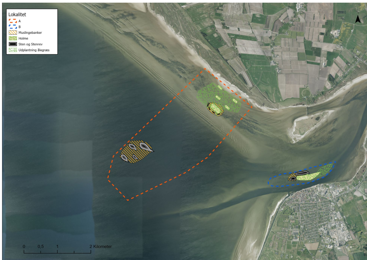
Figur 2: Der anlægges fem holme/fugleøer på lavt vand samt en større holm/fugleø umiddelbart nord for Løgstør. Mellem- og i tilknytning til holmene plantes ålegræs. På lidt dybere vand og mellem holme placeres spredte sten og yderst ud til ca. 4 meter etableres østers og muslingebanker.
