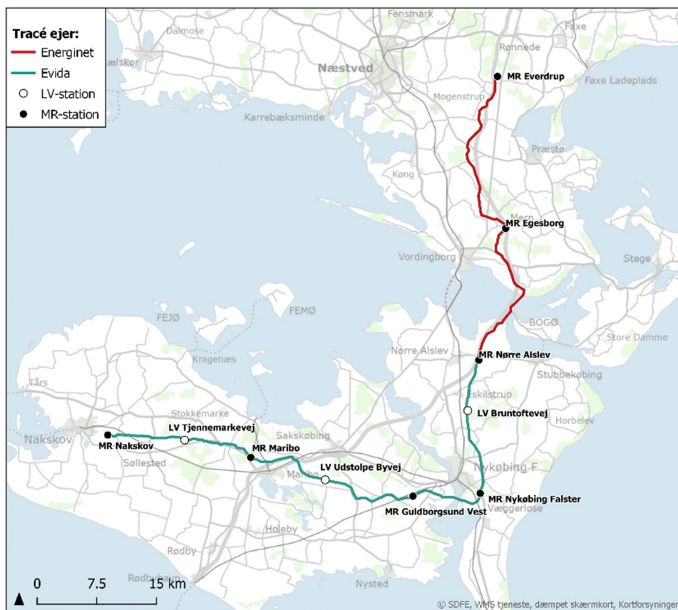
Figur 0.1 Den ønskede linjeføring for Grøn Gas Lolland Falster mellem Everdrup på Sjælland, over Falster og til Nakskov på Lolland.
