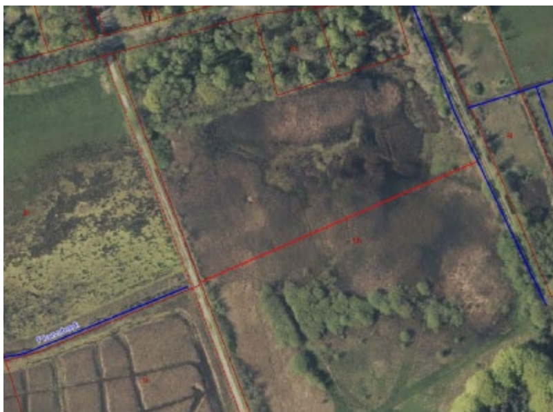
Fig. 2. Tilsendt fra ansøger. Billedet viser den formodede placering på det nedgravede dræn markeret med rød og åbne afvandingsgrøfter er markeret med blå.
