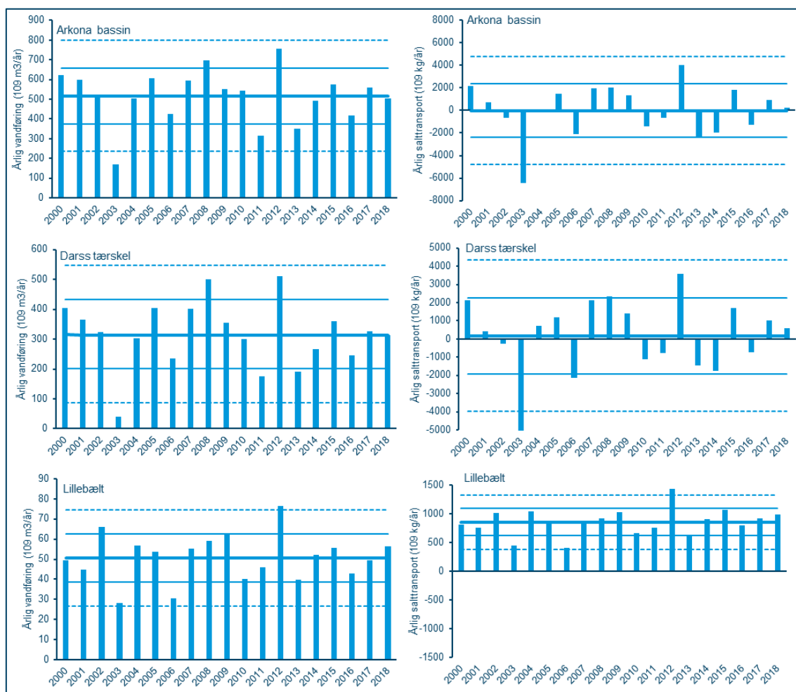
Figur B- 5 Modellerede årlige nettotransporter i perioden 2000 – 2018 af vand (venstre kolonne) og salt (højre kolonne) ud af Østersøen gennem Øresund, Storebælt og Lillebælt. Vandrette linjer angiver middelværdi og henholdsvis én og to standardafvigelse.
