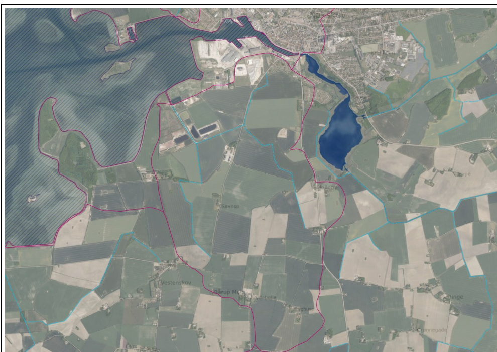
Figur E2. Beskyttede vandløb (lyseblå), som afvander oplandet til Savnsø Vig Kanal (rød afgrænsning). Den samlede vandmængde fra oplandet inkl. roejordsdeponierne udpumpes ved vandskellet til den ydre del af Savnsø Vig kanalen, som har udløb i vandområde 207 Nakskov Fjord. Øst for Savnsø Vig kanal oplandet ligger den målsatte sø 871 Nakskov Indrefjord, hvorfra NS Nakskov indvinder vand til køleformål. Kølevandet udledes sammen med virksomhedens rensede spildevand til Langelandsbæltet/Østersøen.
