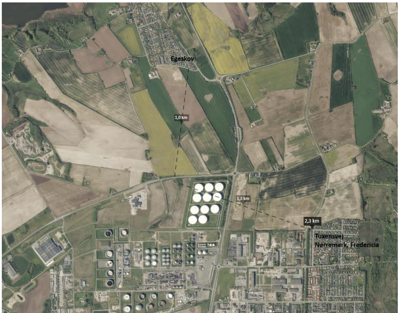
Figur 1: Der regnes generelt med receptorhøjde på 1,5 m og med 5 m i parcelhusområderne ved Egeskov 1,0 km væk og Nørremark 1,3 km væk. Der anvendes en ruhedslængde på 0,1 m for landbrugsarealer med læhegn som klart er den arealkategori der er dominerende omkring fabrikken
