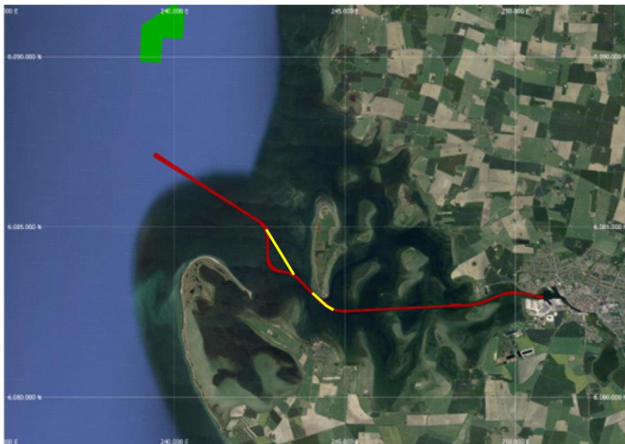
Figur 2-1: Placering af klapplads vist med grøn. Etape 1 er uddybning af den nye sejlrende vist med gult. Etape 2 er udvidelsen af den eksisterende sejlrende vist med rødt (knækket ved siden af den gule linje udvides ikke i Etape 1 og 2).
