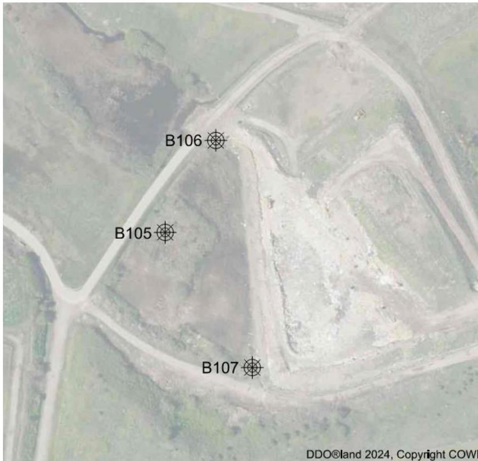
Figur 5 Geotekniske borer udført i marts 2025
