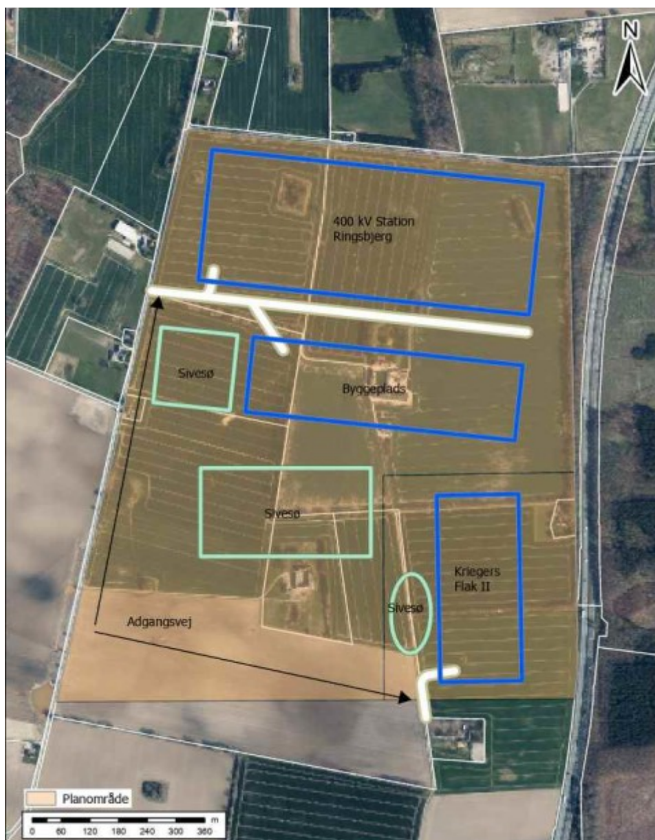
Figur 2. Oversigtskort for Ringsbjerg – alternativ 1. Med blå rektangler er vist placering af højspændingsstationen (øst-vest), byggeplads samt koblingsstationen for Kriegers Flak II projektet. Med lysegrønne streger er vist placering af sivesøer (håndtering af overfladevand). Med hvid tyk streg og tynd sort streg er interne adgangsveje vist. Projektområdet for Kriegers Flak II fremgår af det nederste højre hjørne af figuren.
