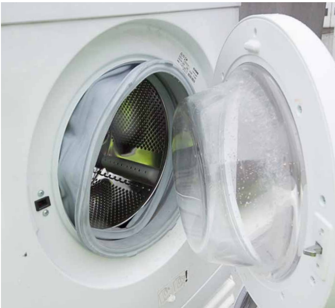
Eksempel på vaskemaskine med tætningsliste, som udviser alvorligt tegn på skade og slitage, og derfor må konstateres ikke at være funktionsduelig.
