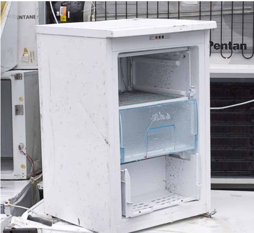
Eksempel på et køleskab, som mangler dør/låge og derfor må konstateres ikke at være funktionsdueligt
