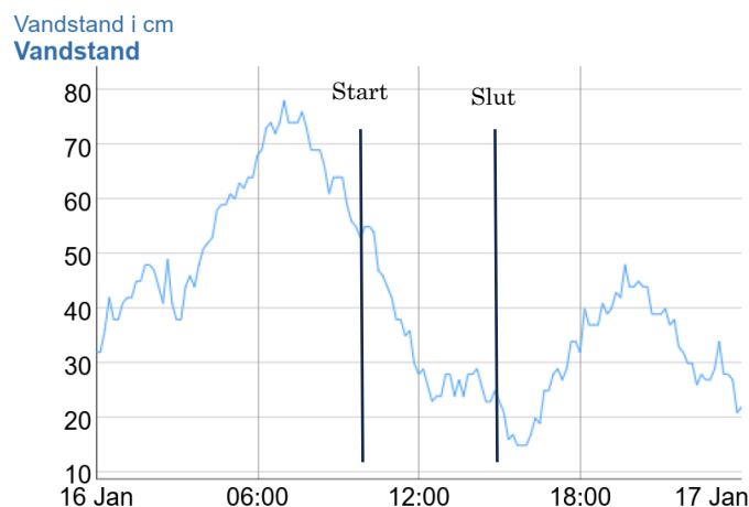
Figur 3. Vandstand i Thyborøn Havn angivet i cm over DVR90, som er målt af Kystdirektoratet og offentliggjort af DMI. Data er endnu ikke kvalitetssikrede og derfor underlagt forbehold. Feltarbejde er udført fra kl. 10-15 den 16. januar 2023.
