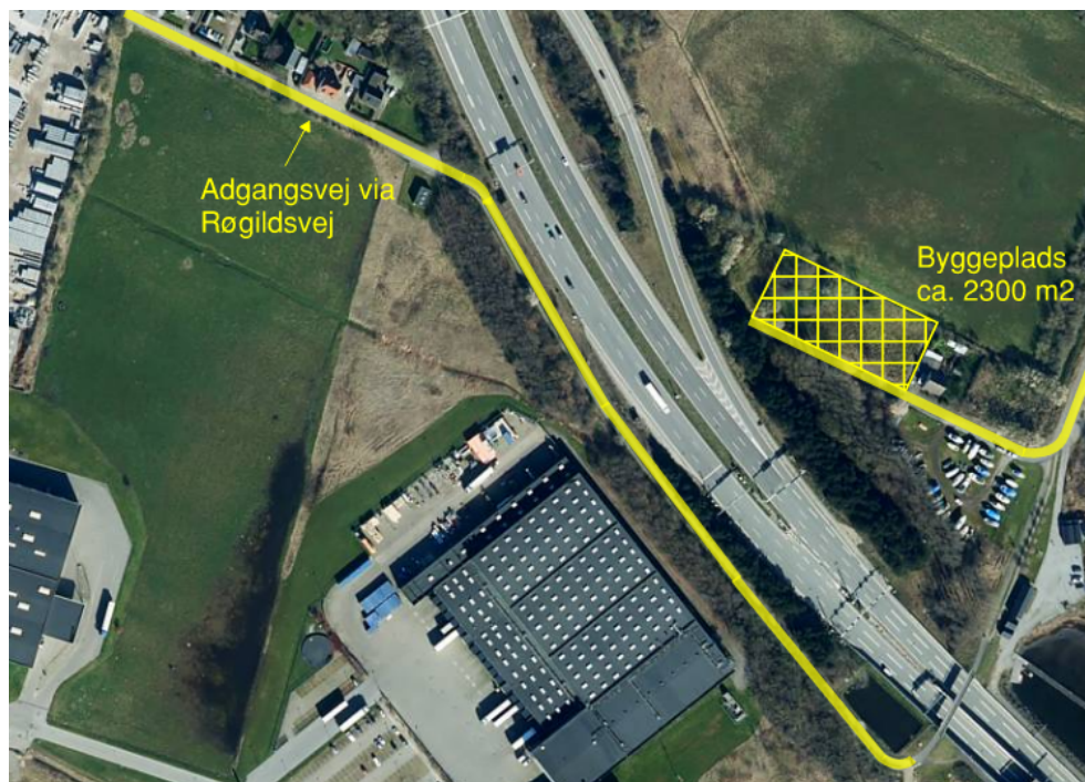
Figur 5-2 Oversigtskort over adgangsvej vest for motorvejen
