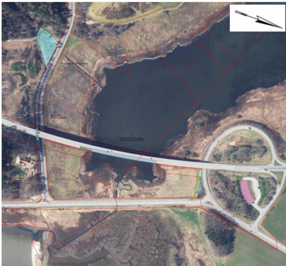
Figur 1, med blå anstillingspladser (+arbejdssted på brodæk), lys rød materialeoplag, rød skravering placering af transportvej med køreplader, gul er eksisterende adgangsvej.
