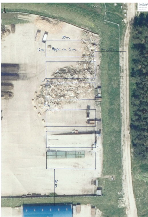
Figur 2B: Placering af miler med brændbart affald på enhed 5B.
