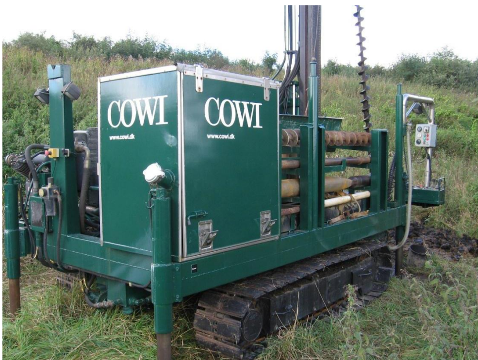
Figur 2-7 Eksempel på geoteknisk borerig, der kører på bæltter. Riggeren på det viste eksempel vejer ca. 7,5 ton.
