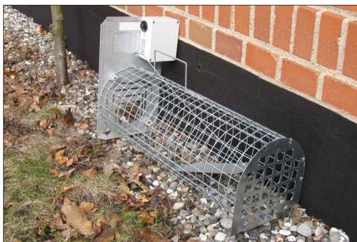
Figur 12: SMS-boks monteret på LOTIN trådfælde ▲
