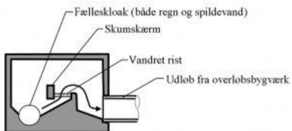
Figur 10-9 Princip for anvendelse af skumskærm i overløbsbygværk. http://holbaek.dk
