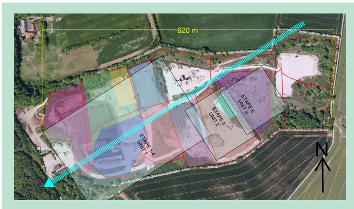
FIGUR 5.2. Inddeling i beregningsenheder. Beregningsenhederne tilpasses, så de er beliggende parallelt med den overordnede grundvandsstrømningsretning (angivet med den blå pil). Længden af hver beregningsenhed svarer til den fysiske enheds længde i grundvandets strømningsretning, mens bredden af en beregningsenhed tilpasses, så arealet af beregningsenheden er den samme som arealet af den fysiske enhed.
