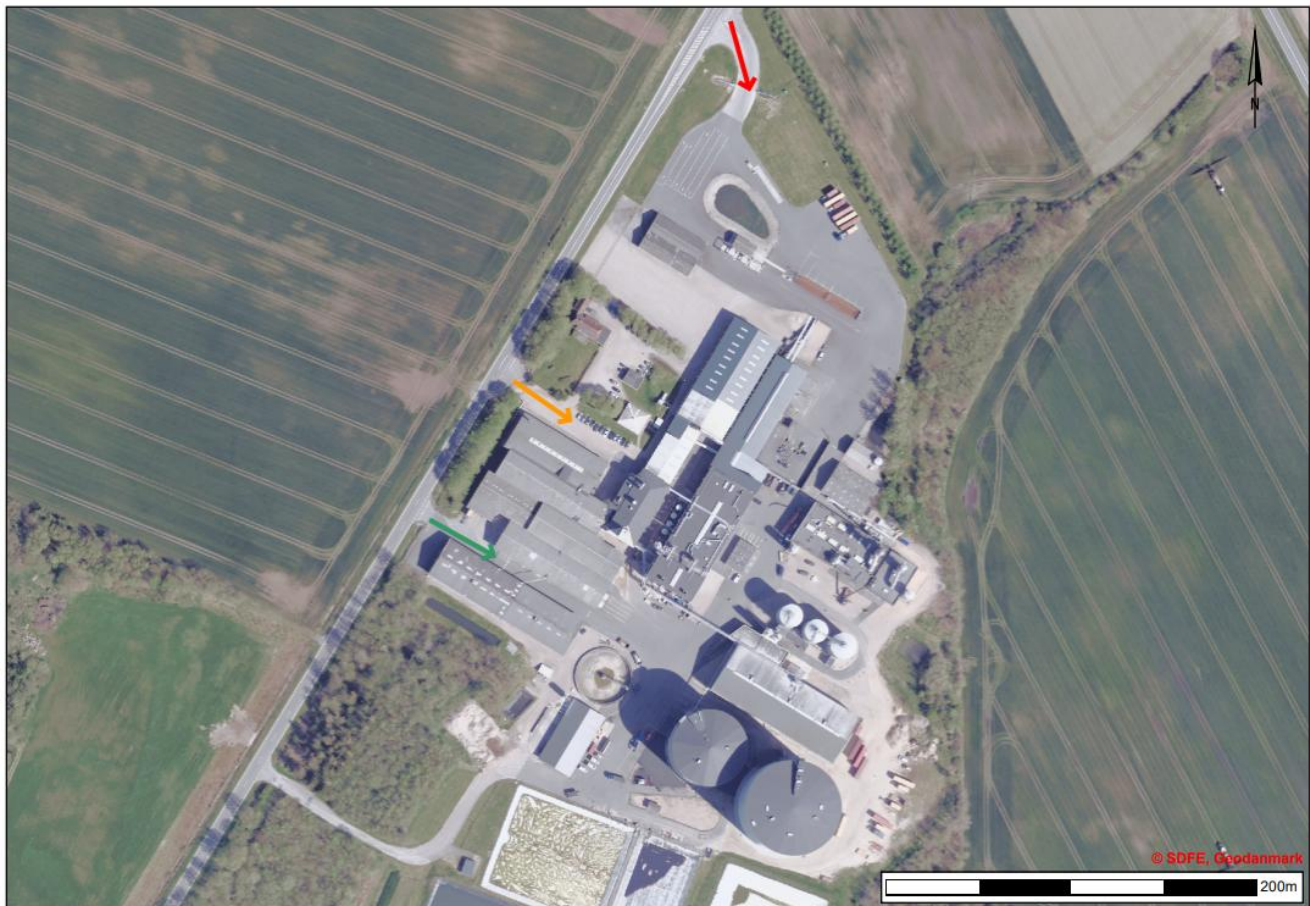
Figur 5.1: Ind- og udkørsel. Rød : Kartoffler ind, sten, pulp m.v. ud. Orange : Personale og gasolie. Rød eller grøn : Udlevering af færdigvarer m.v. Rød eller grøn : Udlevering af protamylasse.
