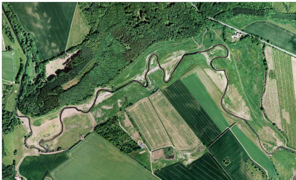
Ved Tørringe Bæk og Onsebakke har Fyns Amt foretaget en genopretning af Odense Å på en ca. 4 km lang strækning (COWI).
