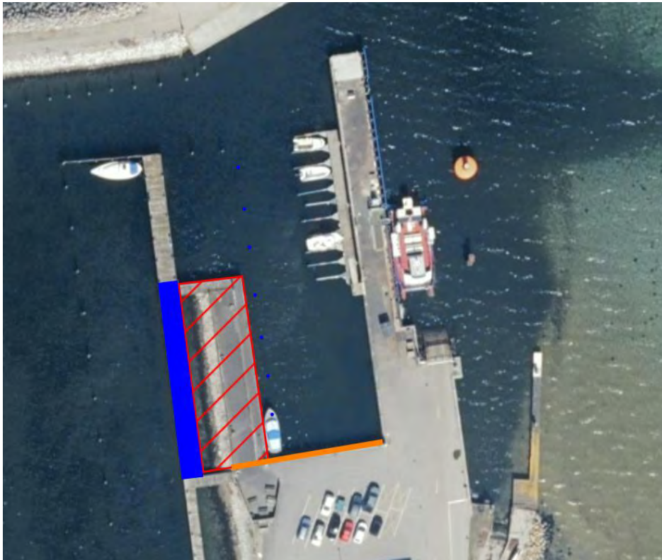
Figur 5 – Illustration af eksist. og fremtidige forhold. De optegnede linjer viser fremtidige forhold, hvor luftfotoet viser eksist. forhold, se også vedlagte tegning 110 og 111. Med rød er markeret nedbrydning af eksist. mole. Med blå er markeret udvidelse af eksist. bådebro. Med orange er markeret renovering og forlængelse af eksist. kaj.
