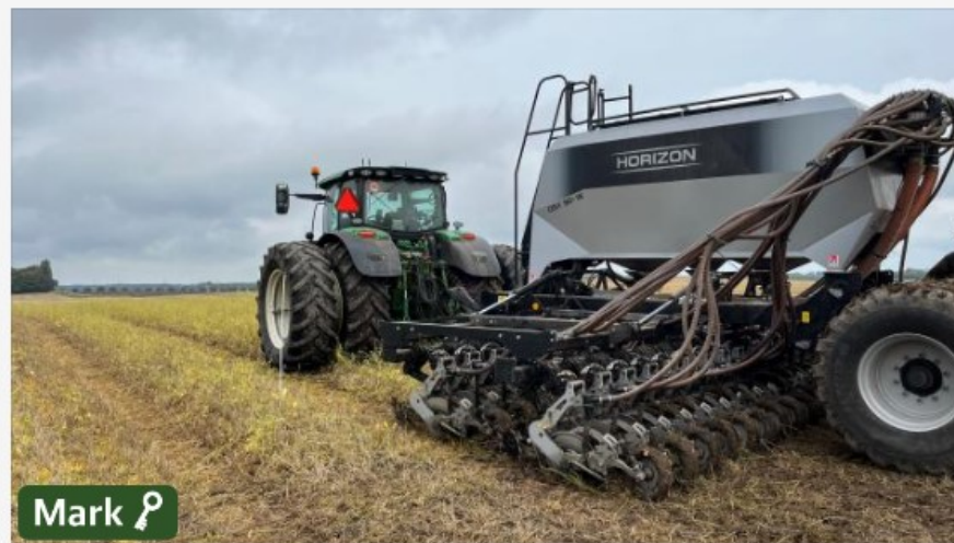
En af de testede såmaskiner: Horizon DSX disc-såmaskine. Foto: Frederik V. Larsen
