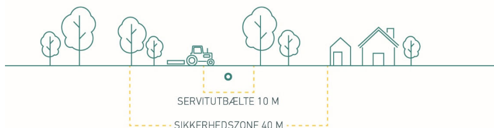
Figur 15 Servitútbælte og sikkerhedszone omkring en gasledning.
