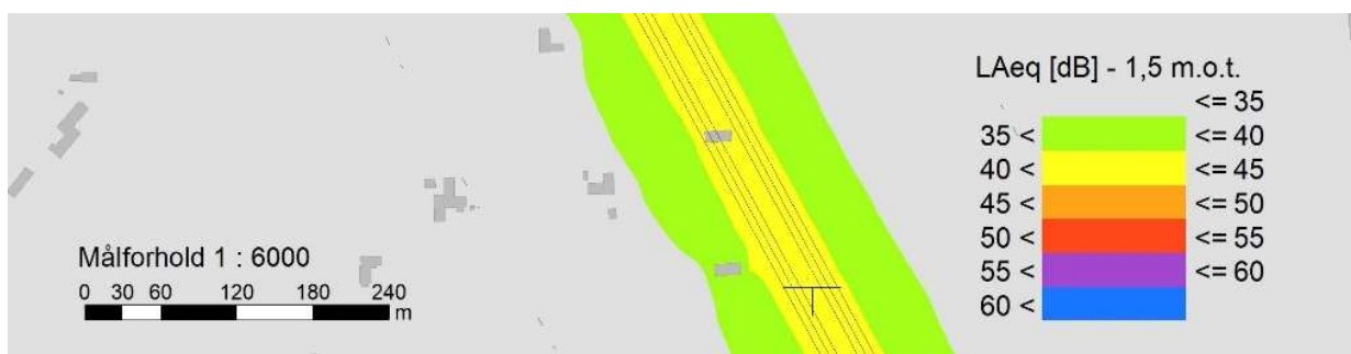
Eksempel på beregnet støjudbredelse, koronastøj fra 400 kV luftledningsanlæg i regnvejr.
