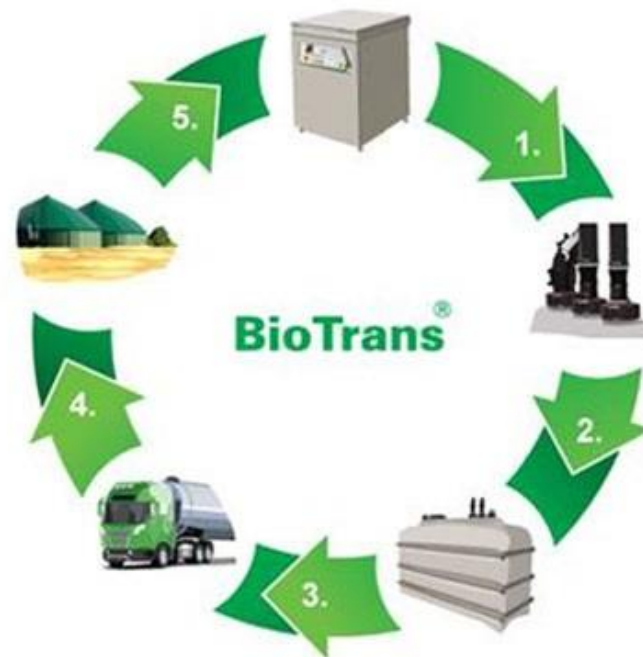
Figur 2: Biotrans Nordics forretningsmodel bygger på neddeling af organisk affald, der opsamles i tanke (1.-2.), hvorfra affaldet afhentes og køres til nærmeste biogasanlæg (3.-4.). Restproduktet fra bio-forgasningen udspre-des på marker og nærer nye fødevarer afgrøder, der kan indgå i kredsløbet.
