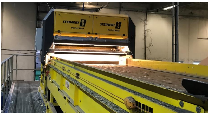
Foto 4 - NIR scanner som fjerner plastik fra glasskår fraktionen
