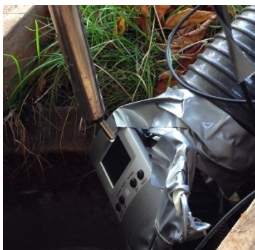
Figur 5 Temperaturmåling i brønden.
