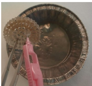
Figur 20 Afbørstning af biofilm fra carriers
