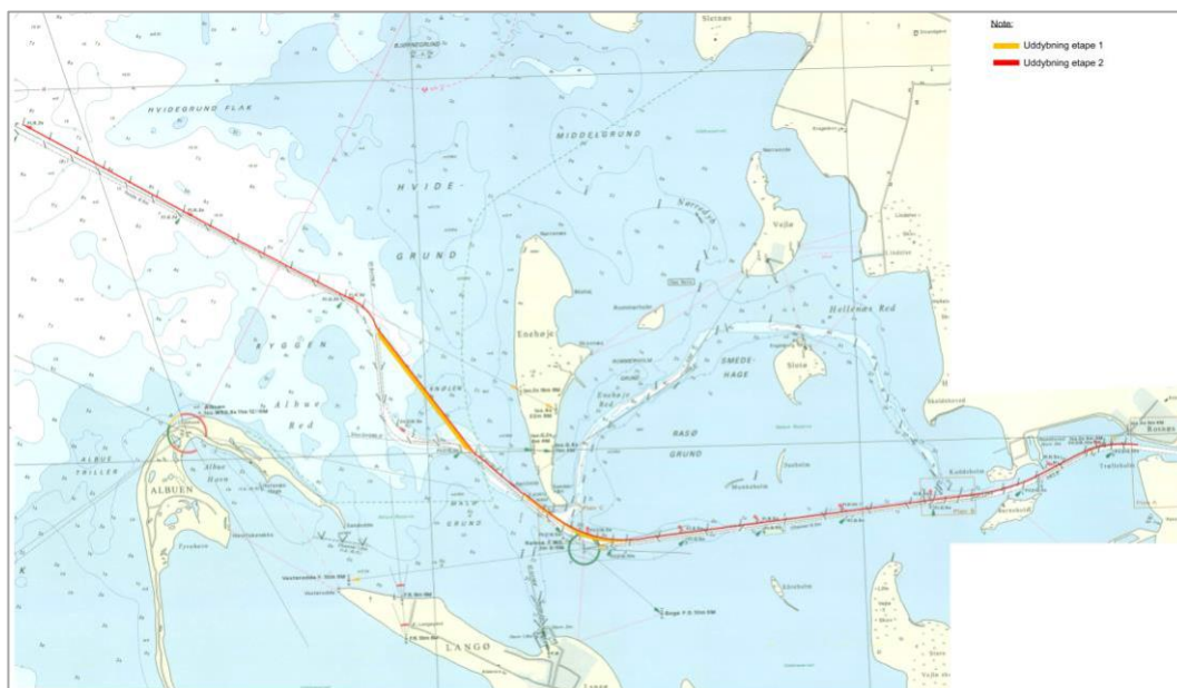
Figur 3-1 Projektet udføres i to etaper, delvis omlægning af sejlrenden i Etape 1 og derefter udvidelse af hele sejlrenden gennem Nakskov Fjord i Etape 2.
