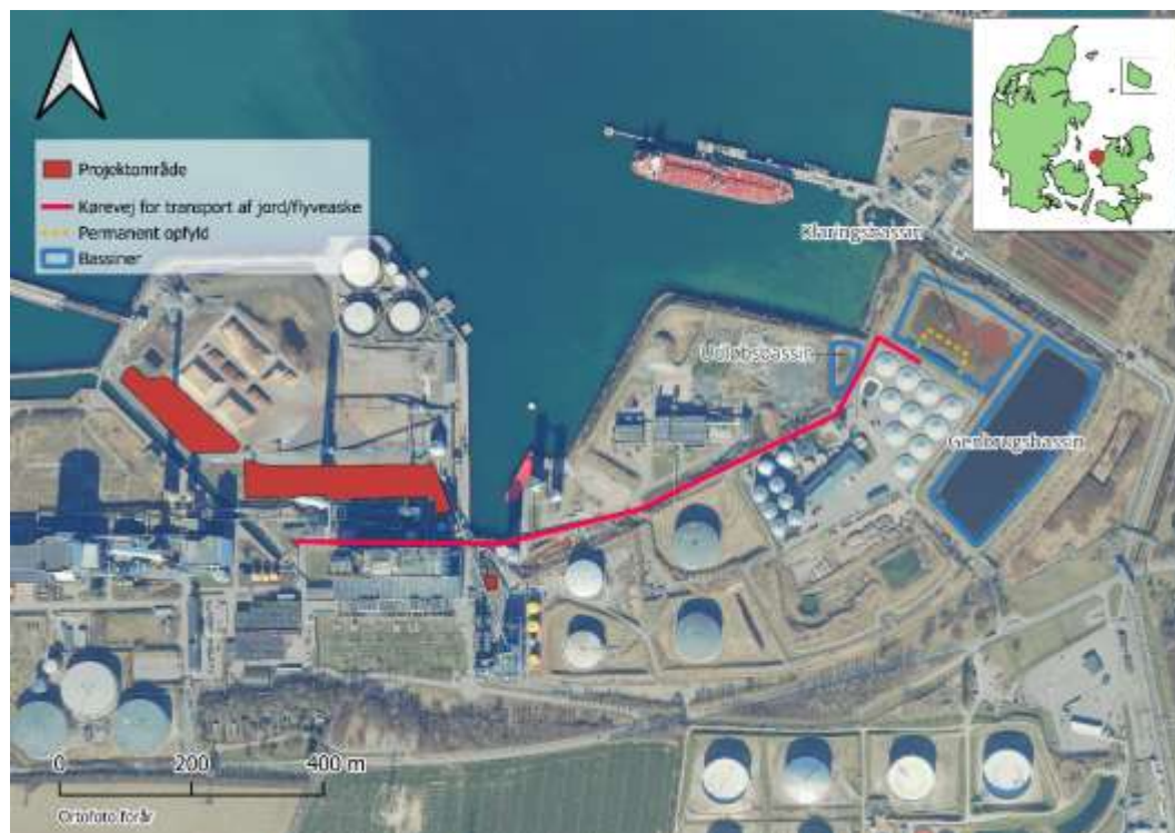
Figur 3-8 Asnæsværket og placering af Klaringsbassin (blå afgrænsninger) samt kørevej for transport af jord/flyveaske og areal for permanent opfyld. De to øvrige eksisterende bassiner (udløbsbassin og genbrugsbassin) er også angivet med blå afgrænsning.
