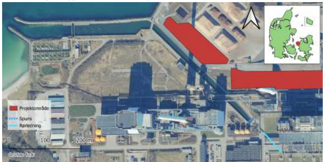
Figur 3-10: Placering af spuns til aflukning og tørlægning af inderste del af kølevandskanal samt rørledning mellem indløbskanal og udløbskanal
