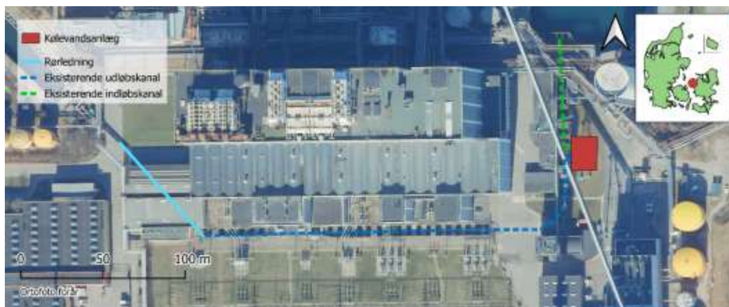
Figur 3-14; Illustration af kølevandsbygning med indtag og udløb
