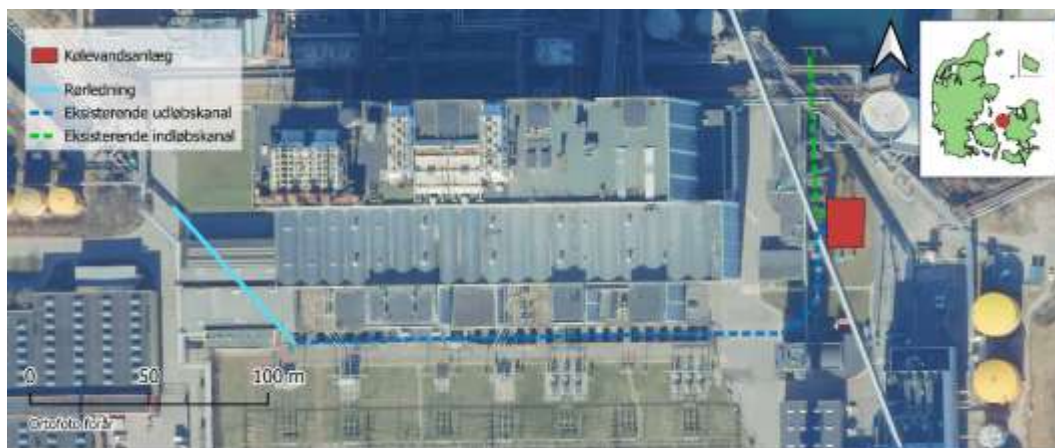
Figur 3-11: Illustration af kølevandsanlæg med indløb og udløb inkl. ny forbindelse til kølevandskanal
