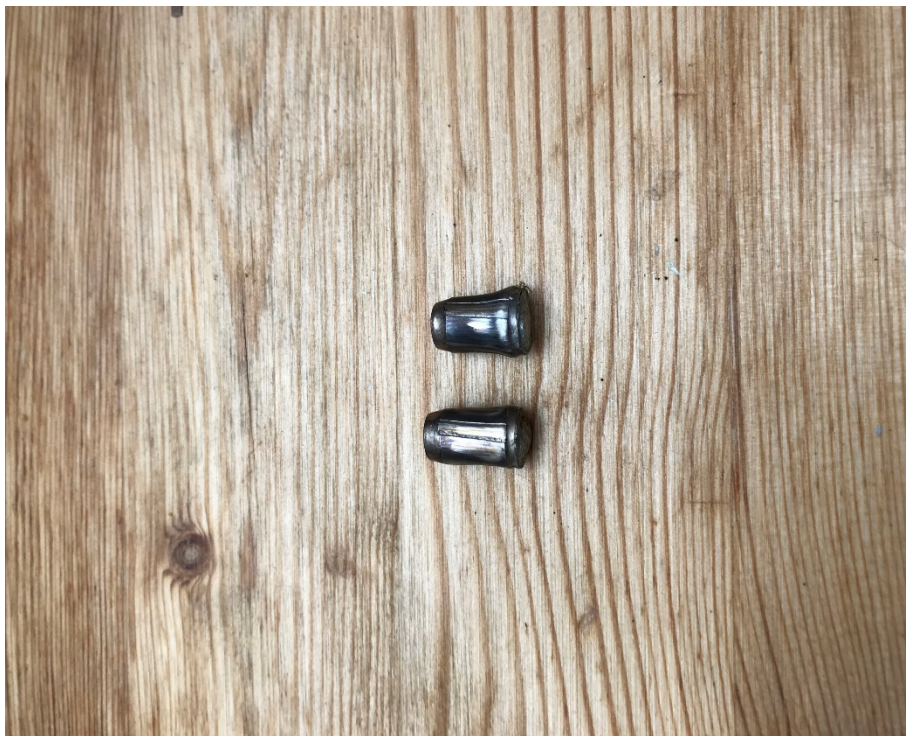
Figur 4. Rester af projektiler, som er stoppet i vildtkroppen. 6,5x57 RWS EVO 6 gram (6557blyfri). Restvægten på disse to var hhv. 3,24 og 3,23 gram, svarende til et væggtab på hhv. 2,76 og 2,77 g. Foto: Niels Kanstrup
